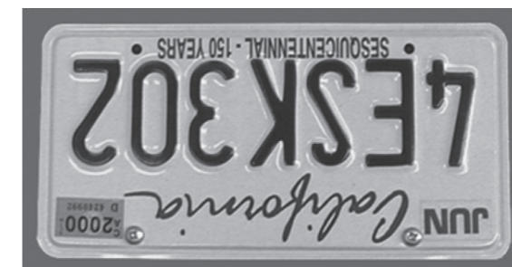
牛顿式反射望远镜上下倒像是，左右反像
