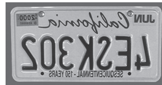
折射望远镜接天顶镜后成左右反像
