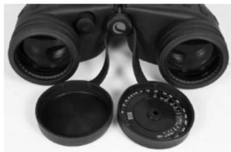
首先，测量目标的视角，转动活动环，把三角形对准视角值。然后，找到目标大小对应的刻度值（参阅下面的方程），刻度值对应一个固定环的点。找到固定环这个点对应的刻度，这个刻度就是距离值。
