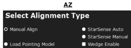
选择开始校准后，会弹出一个带回转控制的窗口。请确认托架处于初始化位置，即赤道仪托架极轴大致准确，重锤杆指向地面，望远镜指向正北，经纬仪托架则是镜筒指向正北，且保持水平。如果需要，用方向键控制望远镜到初始化位置。如果你使用的托架带初始化位置传感器，你可以让托架自动回到初始化位置。托架位于初始化位置后，确认托架离合已经锁紧，然后在“Home Mount”（托架位置初始化）窗口选择“Complete”“结束”。完成托架位置初始化后，托架离合不得松开，所有操作回转操作都只能使用 CPWI 的“Slew Controls”“回转控制”界面。如果你通过 WIFI 或手控器上的 USB 端口连接托架，你也可以通过手控器控制回转。通过手控器控制回转，不影响 CPWI 校准。
