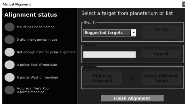
现在，使用“Slew Controls”“回转控制”把目标放到望远镜视野中心。如果目标离的有点远，可以使用寻星镜协助找到目标。把目标居中过程中，最后请使用向上和向右按钮把目标放在正中间，这样可以以最小的齿轮间隙获得较高的校准精度。一旦目标居中了，点击“Object is Centered”“目标已居中”按钮，一个校准点就会加到校准模型里。然后在“Step 1”（步骤 1）下拉菜单选择另一个目标，这一次选择另外一个象限的天体。
