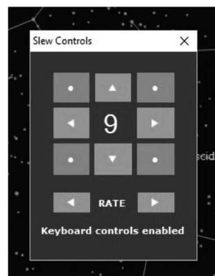
夜间校准托架时，需要通过“回转控制”界面转动望远镜指向一颗选中的恒星并放在望远镜视野中心。一旦居中完成，就成为一个校准点添加到 CPWI 的校准模型里。一个较好的校准模型，建议至少 4 个校准点，天空每个象限一个。
