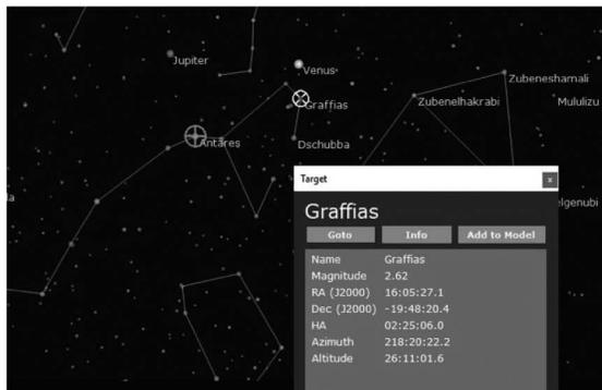
望远镜指向的当前位置在 SkyViewer 部分显示为一个绿色十字线。在 CPWI 里回转望远镜，绿色十字线会随着转动实时变化位置。当在 SkyViewer 选择一个目标时，会在目标上显示一个黄色十字线。
