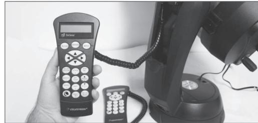
NEXSTAR 手控器已经替换为 StarSense 手控器
