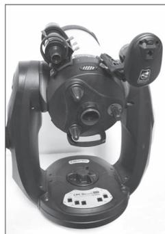
寻星镜和 StarSense 同时安装到 CPC800 上
