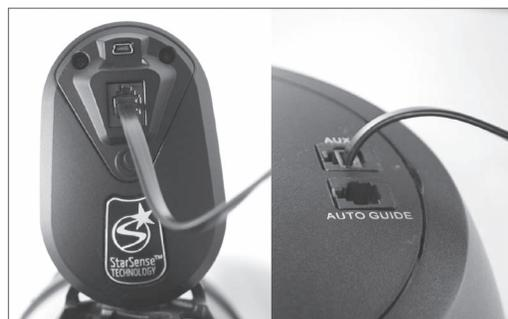
注意：如果你的托架 AUX 端口不足或者没有，你需要使用 AUX 端口复制器（#93919）。把端口复制器一头插入托架 AUX 端口或手控器端口，手控器插入端口复制器。
