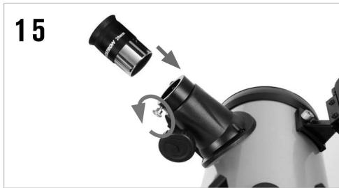
把焦距较长目镜的银色筒子插入调焦筒。适度拧紧锁紧螺丝，固定住目镜。
