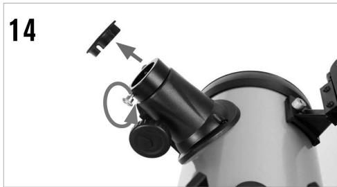
移除望远镜侧面调焦座的防尘盖。松开望远镜后面调焦筒上的锁紧螺丝，直到不在内筒露出。
