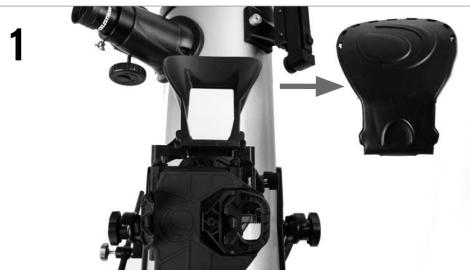
移除 StarSense 手机支架前面的反光镜盖。
