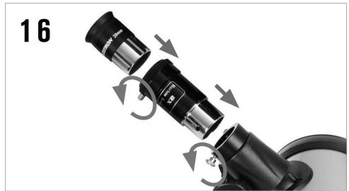
要使用增倍镜，用户需要先从天顶镜上移除目镜，然后把增倍镜比较细的一端插入天顶镜，接着把目镜插入增倍镜的另外一段。使用 2X 增倍镜会使倍率提升到原来的 2 倍。
