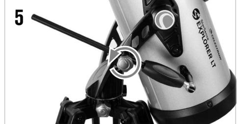
要上下转动望远镜，用户可以一手抓住镜筒，一手松开微调杆导向器固定螺丝。松开后，望远镜就可以上下转动了。接近期望的目标后，适度拧紧固定螺丝。
