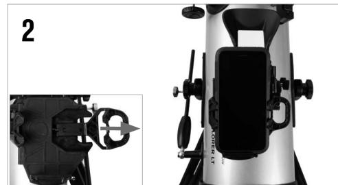
拉开手机支架右侧的弹簧拉手，把手机放入支架，主摄像头一面朝下。慢慢收拢弹簧拉手，固定手机。
