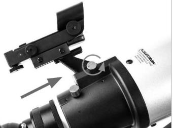
把寻星镜支架鸠尾板完全插入调焦座附近的鸠尾槽内。寻星镜大的一头朝向望远镜观测的方向。拧紧鸠尾槽侧面的锁紧螺丝，固定住寻星镜。
