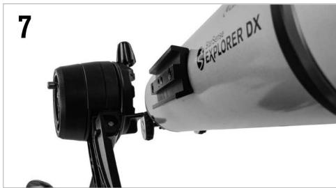
用内六角扳手拧松微调手柄头部的止付螺丝，使它不进入内侧。微调手柄插入微调蜗杆，注意止付螺丝位于微调蜗杆带平面的一侧，并完全插入。使用内六角扳手把止付螺丝锁紧，顶住微调蜗杆平面。把内六角扳手放回存储位置。
