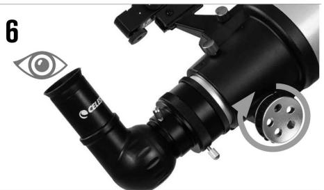
先移除物镜盖。为了获得清晰的像，你需要调焦，仅需转动调焦旋钮。通常镜筒从最短时开始调节，一边观察目镜一边转动调焦旋钮，直到获得清晰的像。
