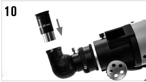
移除天顶镜上的所有防尘盖。松开调焦座侧面的锁紧螺丝，使它不进入内侧，拔出防尘盖。把天顶镜较细的筒子完全插入调焦座，拧紧侧面的锁紧螺丝，固定住天顶镜。你可以松开锁紧螺丝，把天顶镜转到任意位置，然后拧紧锁紧螺丝。
