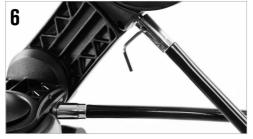
用内六角扳手拧松微调手柄头部的止付螺丝, 使它不进入内侧。微调手柄插入微调蜗杆,注 意止付螺丝位于微调蜗杆带平位的一侧,并完 全插入。使用内六角扳手把止付螺丝锁紧,顶 住微调蜗杆平位。把内六角扳手放回存储位置。
