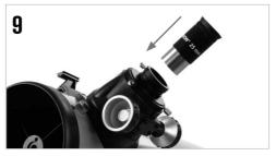
松开望远镜侧面调焦座上的锁紧螺丝, 使它不 进入内侧。把焦距较长目镜的银色接筒完全插 入调焦座。适度拧紧目镜锁紧螺丝。
