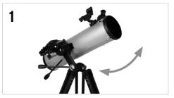
StarSense Explorer DX 托架双轴都有摩擦式离合器。要快速移动望远镜,只需要抓住镜筒,把它推向期望的方向。
