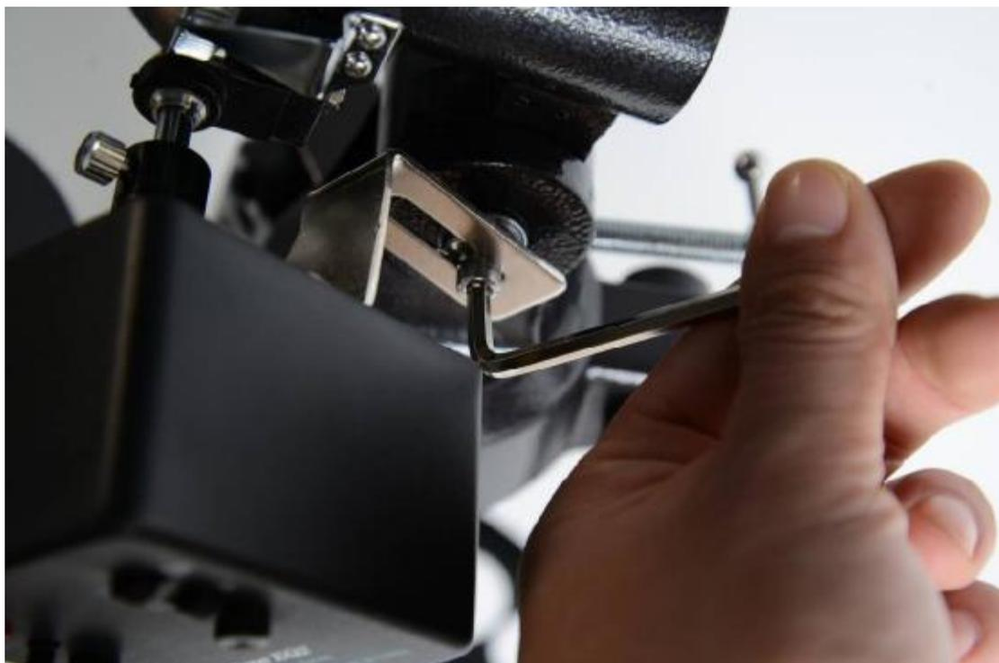
而后将马达连接板 用六角螺丝固定在赤道仪上。
