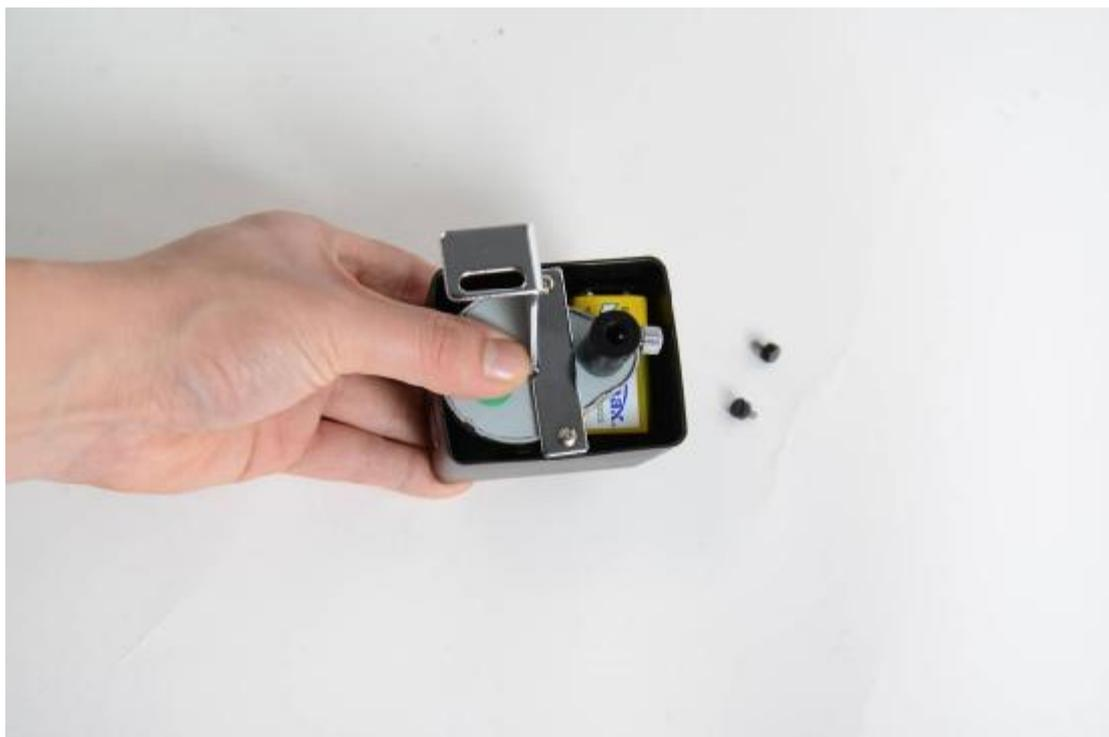
而后装好外壳，拧好螺丝 马达电池安装完毕。
