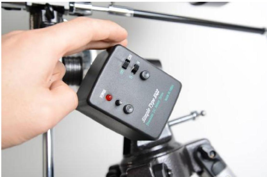
打开电源开关，指示灯点亮，马达即可工作（指示灯下方的旋钮可以调节速率）。
